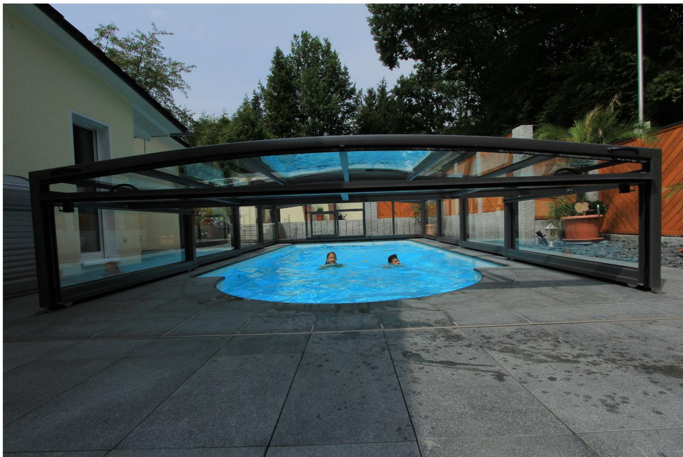
Klar war vom ersten Tag an: Zur Energiespar-Ausstattung des Schwimmbeckens sollte auch eine komfortable Schiebeüberdachung gehören. Die Schiebeüberdachung hält die Wärme im Becken und kann bei schönem Wetter schnell zurückgefahren werden. Und sie ermöglicht den Badebetrieb auch im frühen Frühjahr und im Herbst, wenn andere Pools noch nicht geöffnet sind.
